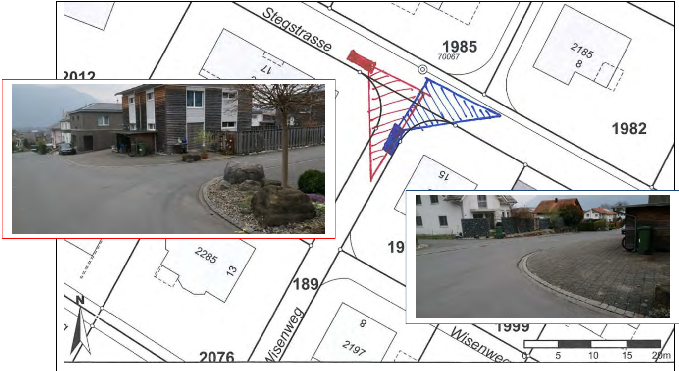
Abb. 33: Sichtfelder an der Einmündung Stegstrasse-Wisenweg
