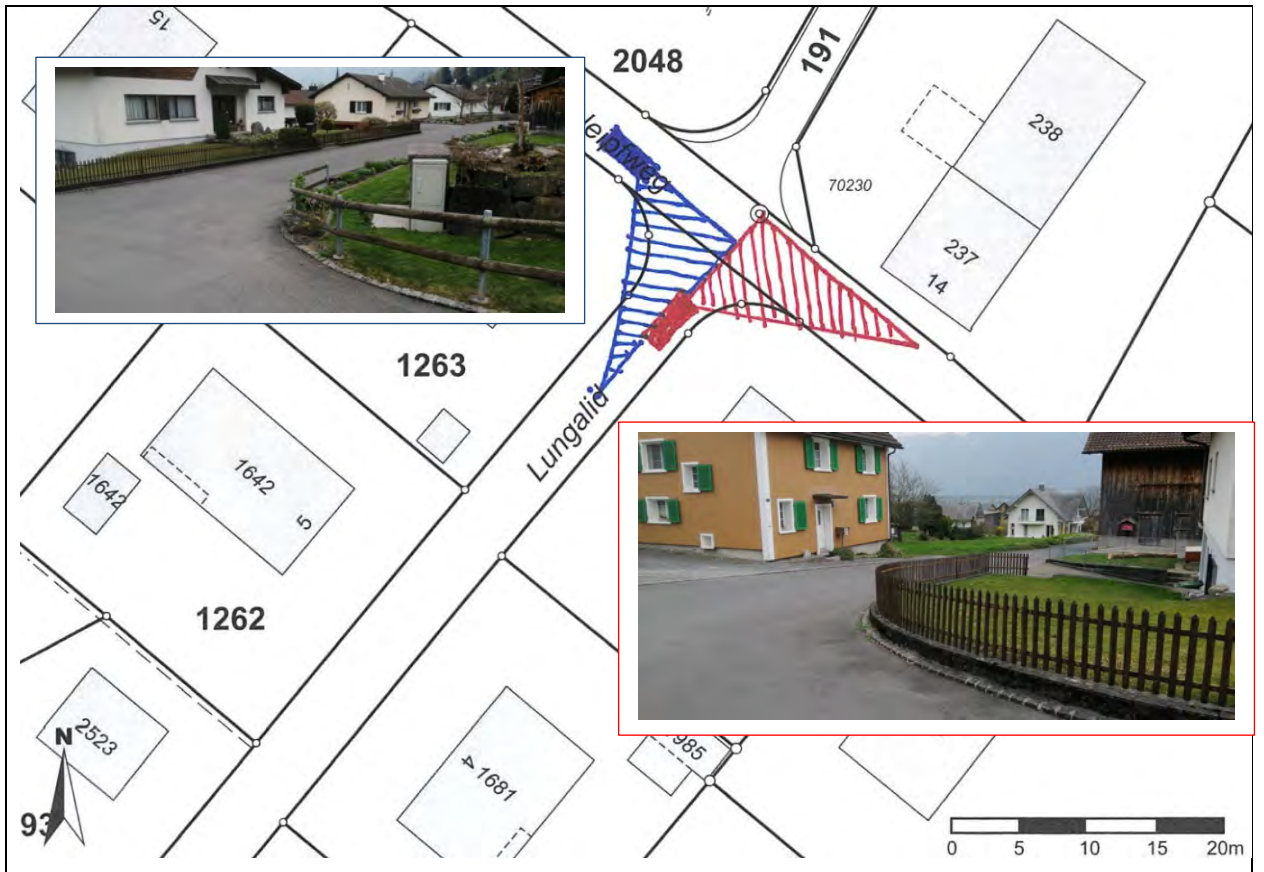
Abb. 38: Sichtfelder an der Einmündung Schleipfweg-Oberhuebweg-Lungalid
