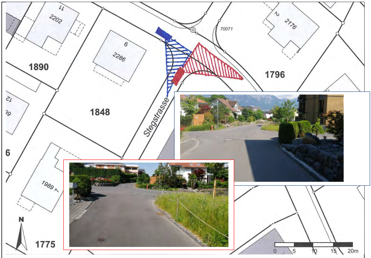
Abb. 32: Sichtfelder an der Einmündung Stegstrasse-Hueb
