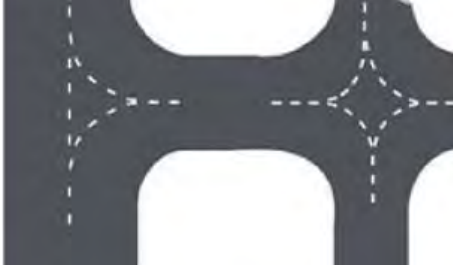
Abb. 26: Beispiele für Markierungen Rechtsvortritt (Quelle: SN 640 851)
