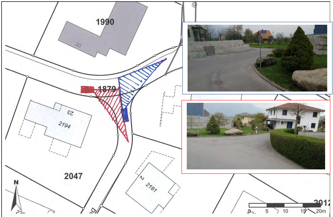
Abb. 35: Sichtfelder an der Einmündung Stegstrasse-Oberhuebweg
