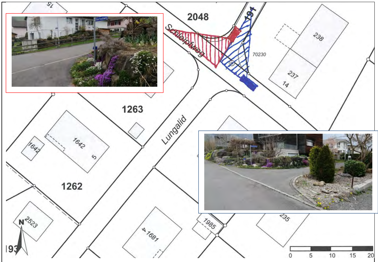
Abb. 37: Sichtfelder an der Einmündung Schleipfweg-Oberhuebweg-Lungalid
