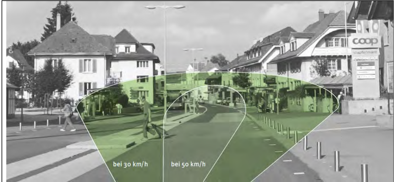
Abb. 4: Unterschiede der Sichtfelder bei Tempo 30 und Tempo 50, Quelle: VCS 2010
